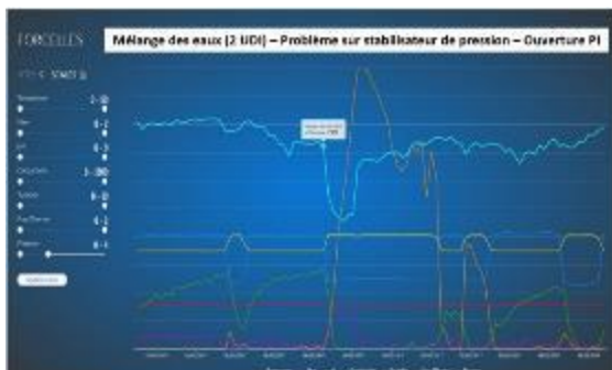
Exemple de suivi d'évènement en réseau de distribution
